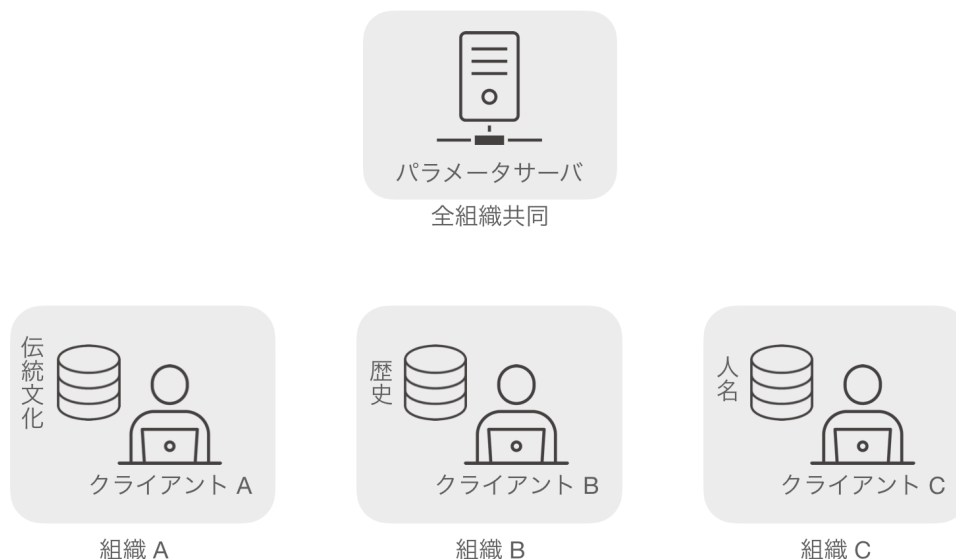
図 19: マルチエージェント強化学習による自己組織化手法のための検証システム構成
