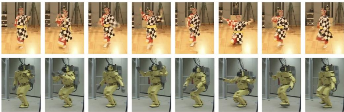
図 3：モーションキャプチャーによる動作解析を用いた模倣ロボットの例 ([7]モーションキャプチャーによる全身運動解析と模倣ロボット - 「じょんがら」節を HRP-1S に踊らせる -より引用)
